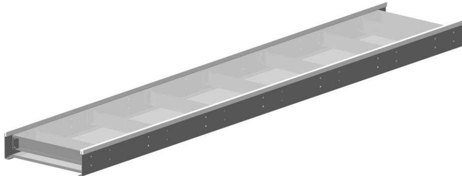
Доборная секция - это основная секция с увеличенным количеством систем отверстий, что позволяет увеличить длину конвейера на длину кратной 373мм.
